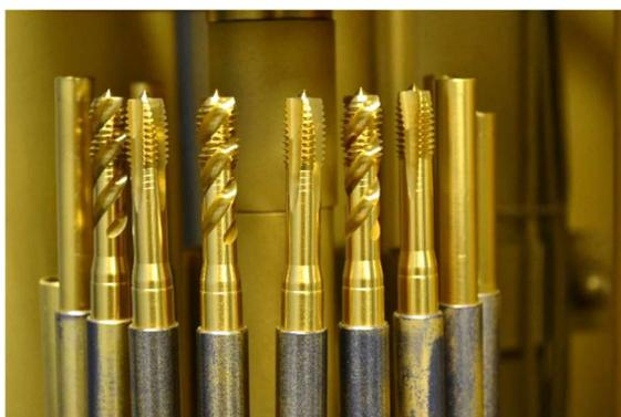
TiN beschichtete Werkzeuge in der Beschichtungsanlage
