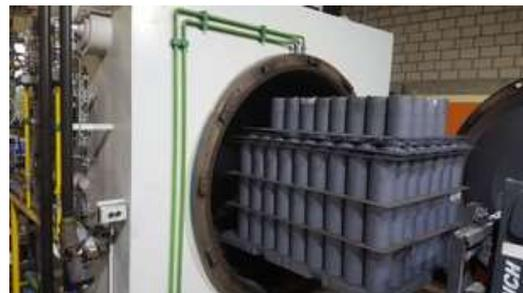
*Charge nach dem Gasnitrocarburieren und Oxidieren*
